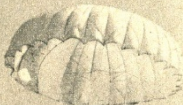
Chinesischer Dreischlitz-Fallschirm mit sehr flacher Kappe – daraus resultieren hohe Pendelanfälligkeit und geringere Vortriebskraft als bei gleichen Konstruktionen mit höherer Kappenauslegung sowie ein hohes Drehmoment.
